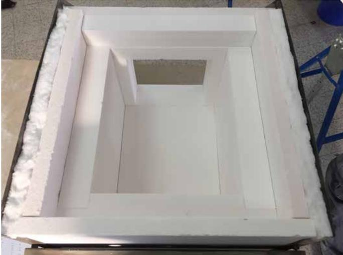
ITM-Fibermax® Matte als „elastischer Dämpfer“ zwischen Außenblech und Platten in einem Hochtemperaturlaborofen. Foto: SCHUPP® Ceramics.
